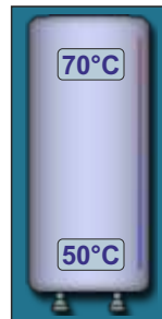
Pufferspeicher mit aktuellen Temperaturen oben und unten
