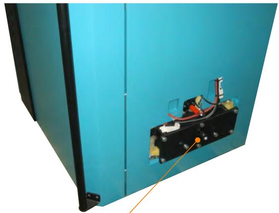
Flansch für die Montage des Mechanismus zur Reinigung des Gitters
