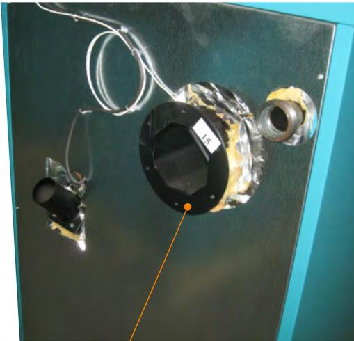
Flansch für die Montage des Ventilators
