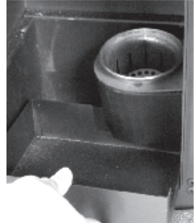
So stellen Sie sicher, dass die Wärmetauscherrohre gereinigt werden. Öffnen Sie die Tür und ziehen Sie die Ascheschublade heraus. Entfernen Sie die Asche, die sich in der Schublade befindet, mit einem Sauger. Dieser Vorgang sollte je nach Menge der verwendeten Pellets mehr oder weniger häufig durchgeführt werden.
