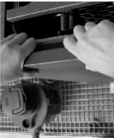
Heben Sie die Ofenfront an, um den Bereich freizulegen, in welchem sich die T-Kupplung befindet.
