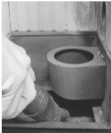
Entfernen Sie den Boden der Brennkammer mithilfe eines Schraubendrehers unter der Platte und sauber mit einem Staubsauger.
