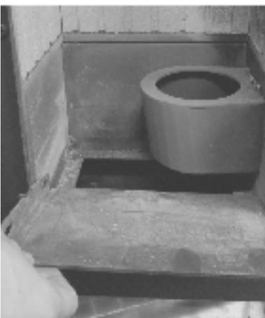
Entfernen Sie die Brennschale und reinigen Sie alle Rückstände.
