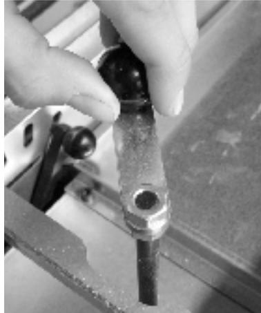
Ziehen Sie den Abstreifer heraus, indem Sie den schwarzen Knauf nach oben führen. Bewegen Sie den Abstreifer 5 bis 6 Mal, indem Sie den Knauf heben und senken.
